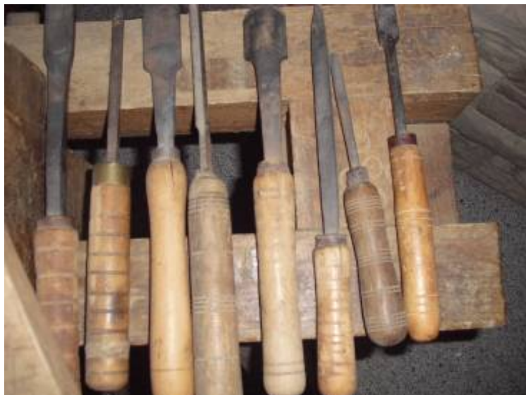
Diferents eines per tornejar la fusta: gúbies, gúbies de gravar, informadors i trencadors. Foto Jan Clarassó
